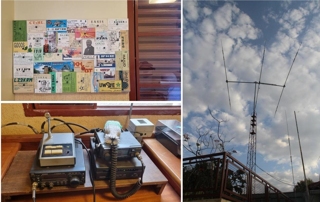
Imagem: Estação de Eni (PT2CA), simples mas muito eficaz, podemos ver um Transmissor HF Kenwood TS-50S, em conjunto com um transmissor VHF analógico, onde mantém QAP no repetidor da cidade. Também podemos ver um quadro com mais QSLs de colegas e estações especiais em Esperanto. Finalmente você pode ver sua antena Yagi de 3 elementos se preparando para seu próximo DX
